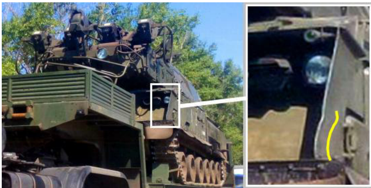
«Бука 3х2» — вмятина на пластине в передней части левого борта 37
